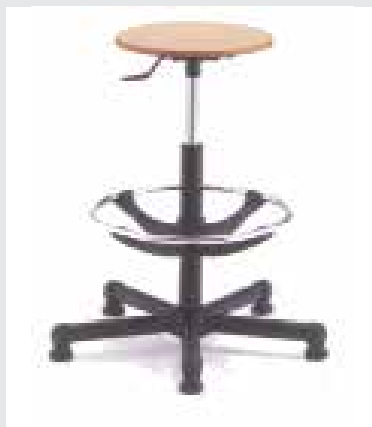
Tabouret Réglable par Lift Gaz Assise ronde galbée de 340 mm en multipli de hêtre feuilleté verni 22 mm. Structure à 5 Branches en Aluminium ou ABS Noir (au choix), réglable de 540 à 800 mm de hauteur. Modèle à vérin à gaz, réglage en continu par manette latérale. Proposé sur patins (ou sur roulettes en option). Livré avec repose pieds.
