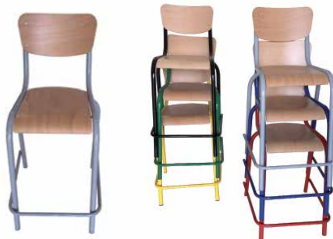
Chaise Réhaussée de Laboratoire (Tabouret fixe avec dossier) Assise et Dossier galbés en multipli de hêtre feuilleté verni 8 mm. Structure en tube d'acier 25 mm avec barre repose pieds anti-écartement. Peinture Epoxy - Coloris selon palette "ral". Hauteur d'assise 580 mm.
